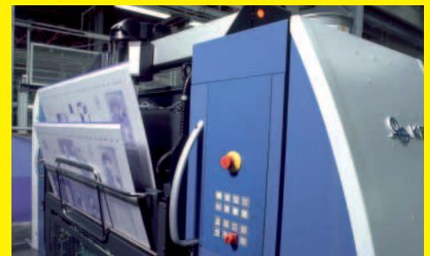
■ Verlässliche Aussagen über den Energieverbrauch von Druckmaschinen werden immer wichtiger. Für eine komplexe energetische Betrachtung von Druckmaschinen sind die genaue Kenntnis der Energieflüsse und deren zeitliche Verläufe während der Produktion unabdingbar. Anhand von Messungen ermittelte die Koenig & Bauer AG Kennwerte, mit denen eine Energiebilanz für eine Bogenoffsetmaschine aufgestellt werden kann. **Seite 22**
